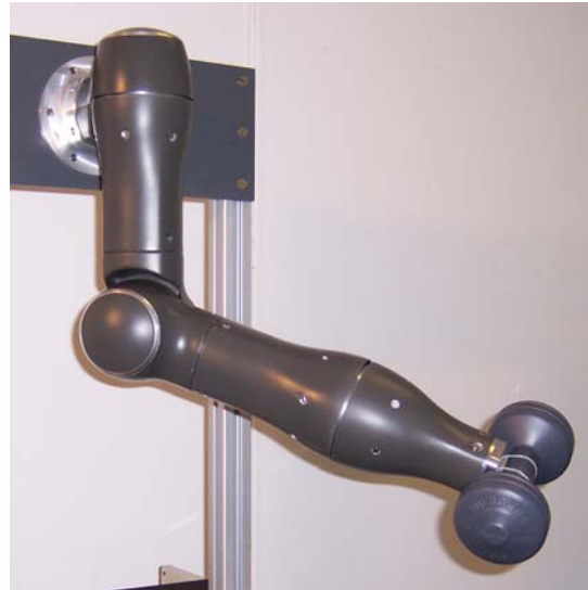
Bild 4: Leichtbau-Roboterarm mit nachgiebigen fluidischen Gelenkantrieben
