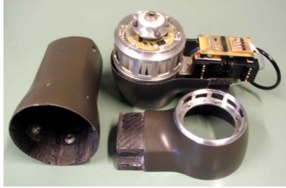
Bild 3: Leichtbau-Roboterarmgelenkmodul in hydraulischer Ausführung
